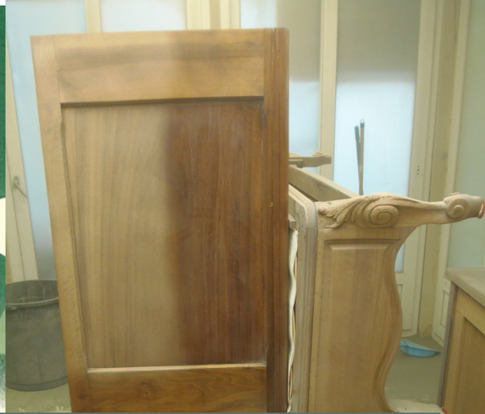
aérogommage (à droite,avant; à gauche,après)
